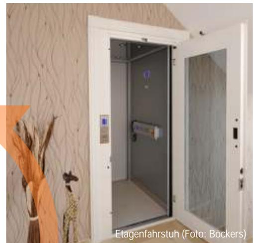
Die Kabine sollte einen Handlauf und ab 40 cm O.K. Fußboden bis ca. 160 cm Höhe einen Glasspiegel aus Sicherheitsglas gegenüber der Aufzugstüre haben. Er dient als Orientierungshilfe für den Rollstuhlfahrer beim Rückwärtsfahren. Blendfreies Licht und ein Klappsitz sollten ebenfalls zum Standard gehören.
